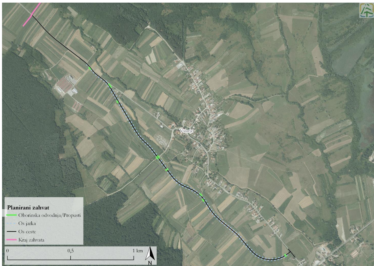
Slika 2.2 Planirana oborinska odvodnja i os jarka duž planiranog zahvata (Izvor: Idejni projekt i Geoportal DGU)
